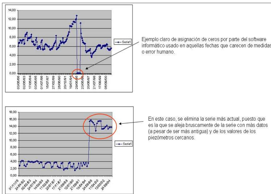
**Figura 14.** Ejemplo de representación y eliminación de datos de piezometría
